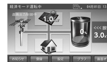
蓄電池リモコン画面
