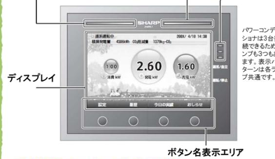
「連系運転」⇔「自立運転」の切り替えは、必ず、日中太陽光発電が発電中に操作してください。夜間や雨天など、太陽光発電が発電していない(簡易モニターが消灯して、何も表示されていない)ときは、操作できません。
